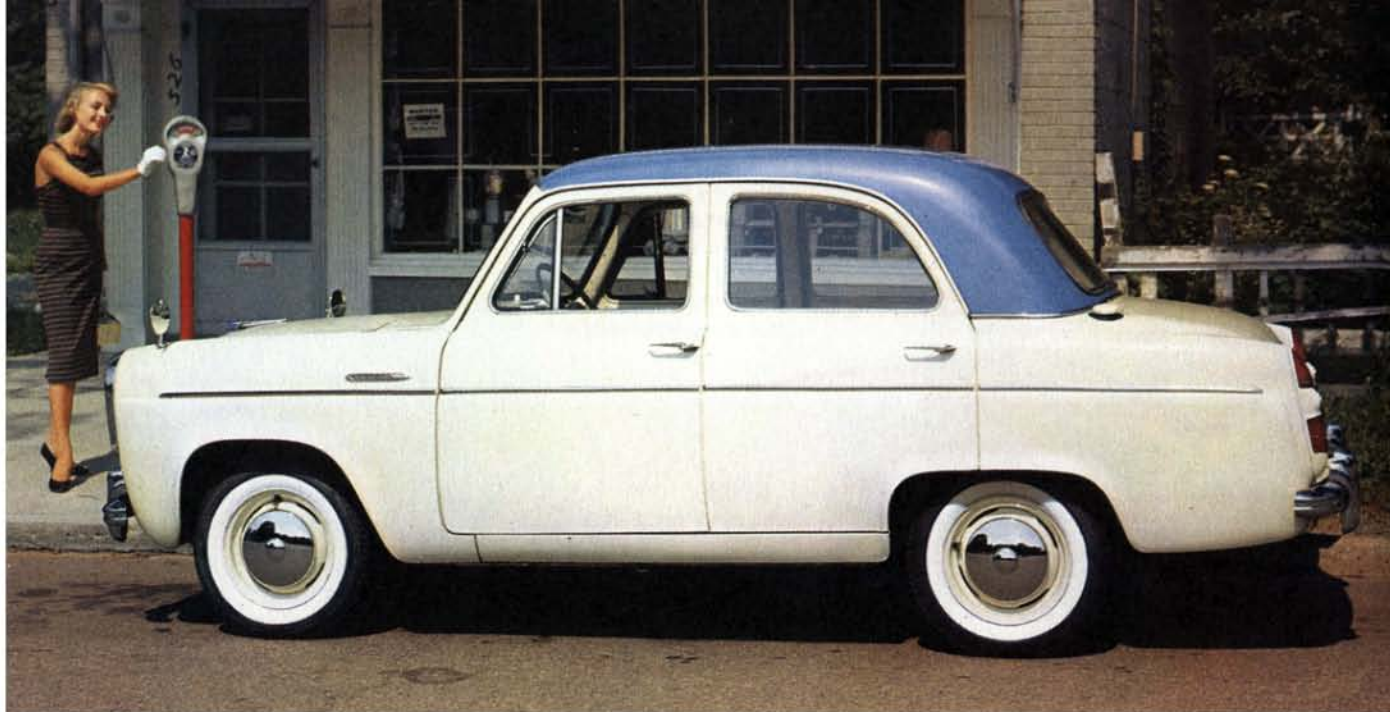
Четырехдверный английский Форд Префект, длиной чуть больше 12 футов, имеет четырехцилиндровый мотор, что снижает расход топлива и облегчает управление в городском движении.
