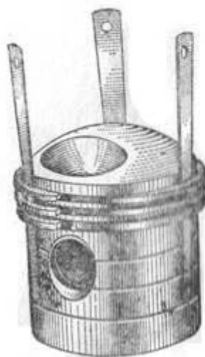
Фиг. 25. Снятие и надевание поршневых колец с помощью пластинок жести.
