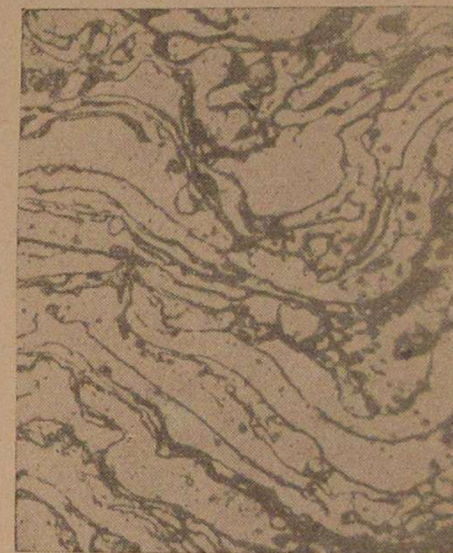
Фиг. 9. Микроструктура напыленного слоя алюминия. \times 200 .
