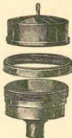
Рис. 144. Барабанъ сепаратора Мелоттъ въ разобранномъ видѣ безъ вставки.
