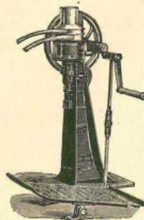
Рис. 108. Сепараторъ модели 1911 г., Альфа-Лаваль В II Регина съ подвижнымъ приспособленіемъ.
