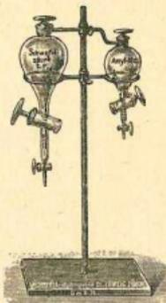
Рис. 81. Бюретки для отмиривания сирной кислоты и амилваго спирта.
