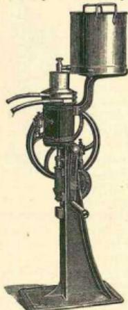
Рис. 103. Ручной сепараторъ де-Лавала Альфа-Бэби высокой SH, модели 1898 г.
