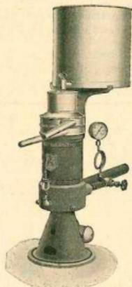
Рис. 172. Паро-турбинный сепаратор Корона.
