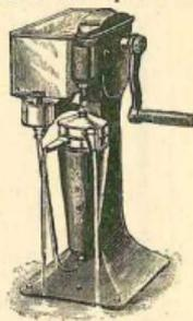
Рис. 138. Сепараторъ Тубуляръ.
