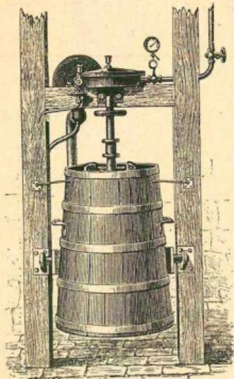
Рис. 196. Паро-турбинная масляная.
