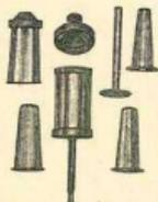
Рис. 117. Вставки въ барабанъ сепаратора Корона R.
