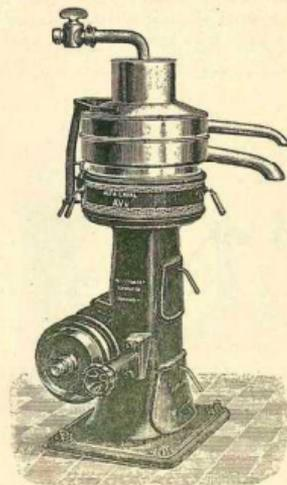
Рис. 153. Сепараторъ Альфа-Лаваль модели 1910 г., работающій безъ передаточнаго станка.
