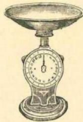
Рис. 36. Пружинные вѣсы.
