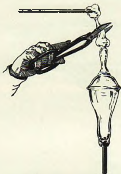
30. Вторая подача стекла для формирования основания ножки бокала «мещёдкой»
