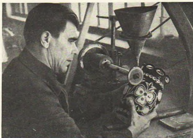
218. Мастер П. А. Порохов. Гравировка медным колесиком. Ленинградский завод художественного стекла
