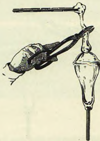
27. Первая подача стекла для формования ножки бокала
