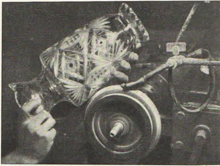
219. Резьба абразивным кругом. Ленинградский завод художественного стекла
