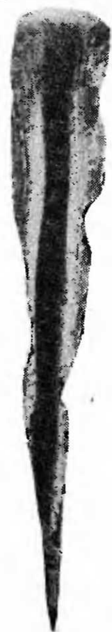
Фиг. 40. Макроструктура многослойного лезвия косы.
