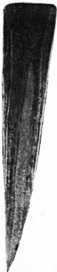
Фиг. 43. Макро-структура лезвия топора.
