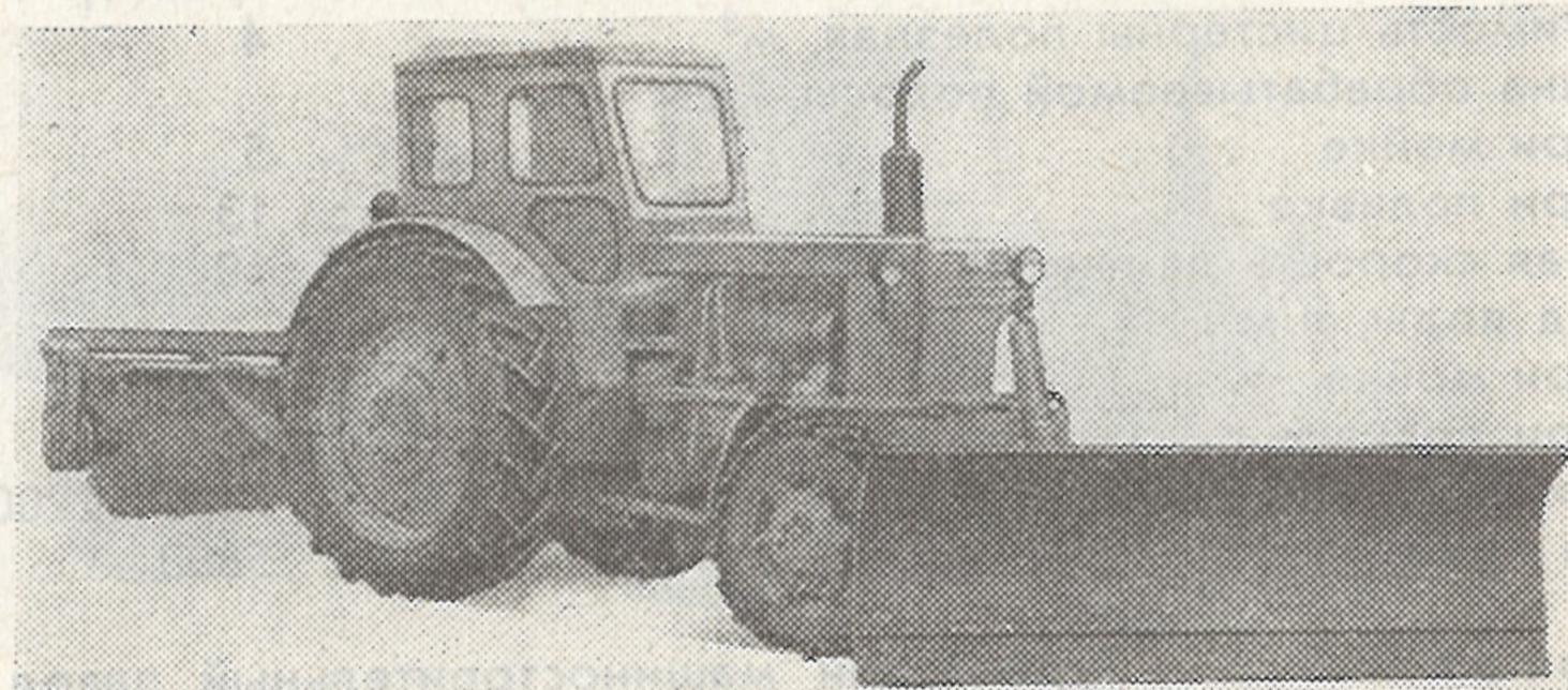
Предназначено для очистки от свежесвыпавшего снега усовершенствованных дорожных покрытий.
