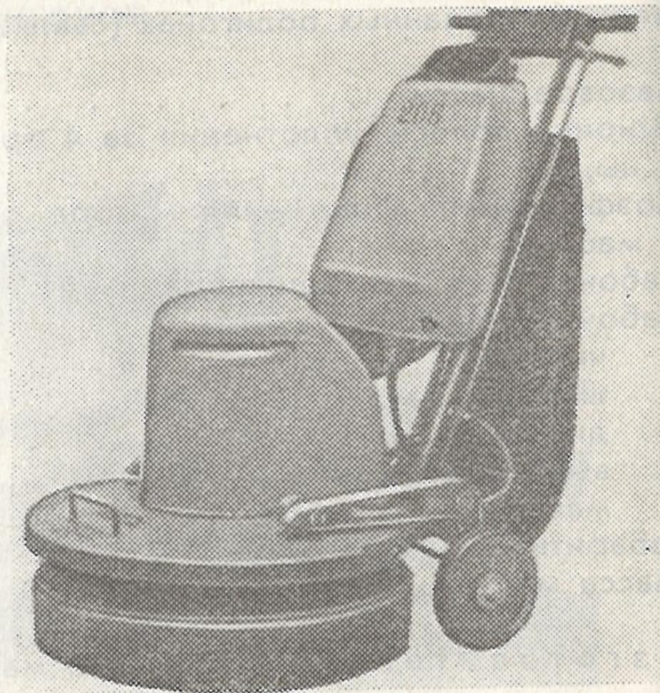
Предназначена для натирки паркетных, линолеумовых и пластиковых полов с одновременным отсосом образующейся пыли; сухой и мокрой уборки полов (без удаления отработанного раствора) в зданиях общественного назначения.
