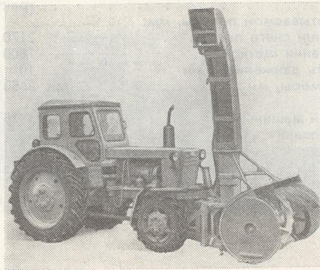
Предназначено для перекидки снега, собранного в валы и кучи, на резервную зону, а также для погрузки его в транспортные средства.
