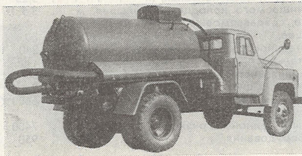
Предназначена для механизированной очистки выгребных ям от фекальных жидкостей и доставки их к месту обезвреживания в условиях низких температур (до  $-30^{\circ}\text{C}$ ).
