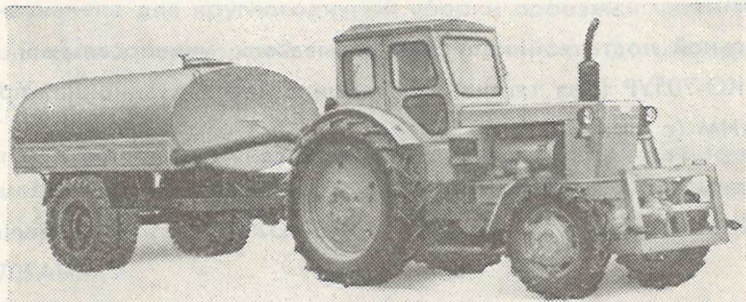
Предназначено для поливки и мойки дорожных покрытий, а также для поливки зеленых насаждений.
