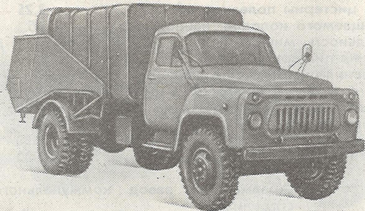
Предназначен для механизированной загрузки мусора из стандартных контейнеров и транспортирования его в места обезвреживания и утилизации.
