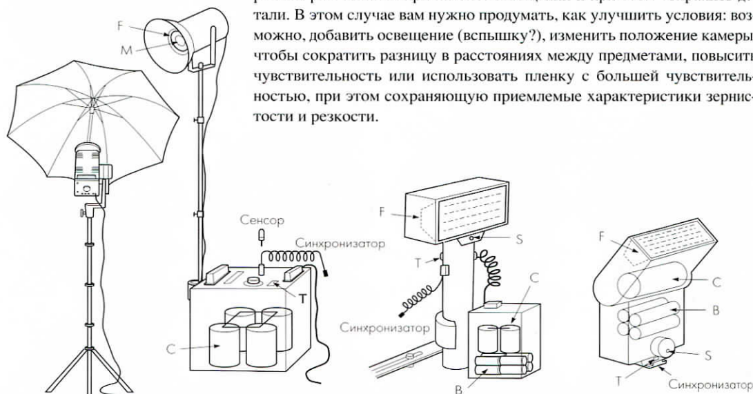
Рис. 10.25. Вспышка. Студийное оборудование и внешние дополнительные вспышки со светочувствительными сенсорами и системой синхронизации. Энергия поступает из батарей (В) или (в случае студийного оборудования) из электросети и заряжает конденсаторы (С). Когда срабатывает спусковая кнопка затвора, тестовая кнопка (Т) на вспышке или световая ловушка, на вспышку (F) подается заряд и происходит вспышка. М: галогенная лампа-пилот. S: сенсор-фотоэлемент, измеряющий отраженный от объекта свет и регулирующий длительность вспышки.
