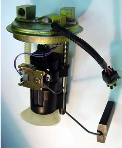
После поворота ключа зажигания включается главное реле ЭСУД и реле бензонасоса. Характерный звук работающего насоса может служить первым признаком его работы. Если насоса не слышно (мешают посторонние звуки, насос тихо работает и т.п.), откройте заднее сидение и доберитесь до лючка бензобака - в этом месте гарантировано слышно работающий насос.
