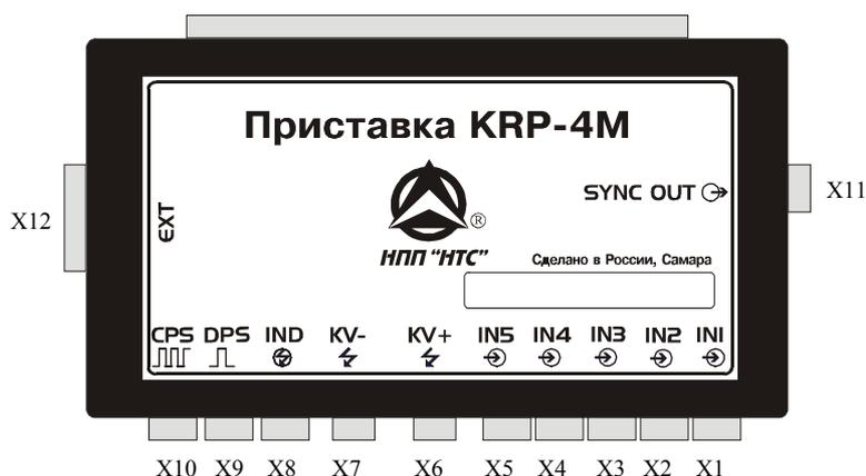
При подключении к адаптеру KR-4 приставки KRP-4M пользователь получает полноценный мотор-тестер с возможностью подключения различных датчиков с отображением данных на экране компьютера.
