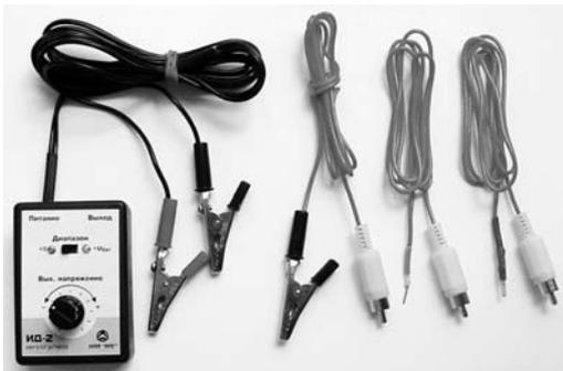
Имитатор датчиков ИД-2 предназначен для имитации выходного напряжения потенциометрических и резистивных датчиков электронной системы управления инжекторных двигателей. Имитатор датчиков ИД-2 позволяет определить, что является причиной неисправности: датчик, жгут или блок управления. ИД-2 позволяет имитировать следующие датчики:
