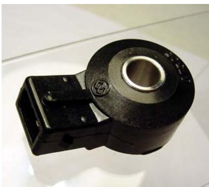
Система гашения детонации в автомобиле позволяет гибко корректировать угол опережения зажигания в двигателе, работа которого по каким-то причинам отличается от нормальной. К таким причинам относится и плохое топливо и регулировка клапанов, сбой в системе охлаждения и т.д.
