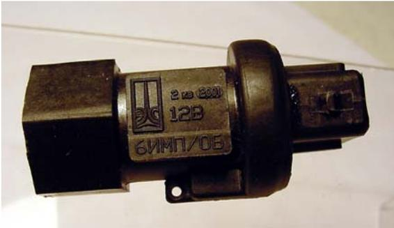
(при неисправном датчике скорости) не позволяет ей определить, движется автомобиль или стоит. Только наличие больших оборотов двигателя в сочетании с большой нагрузкой (косвенно определяется по расходу воздуха) дают возможность провести диагностику датчика скорости, именно при этих условиях считается, что автомобиль движется, т.е. импульсы с датчика скорости должны присутствовать в системе. В противном случае определяется его неисправность.
