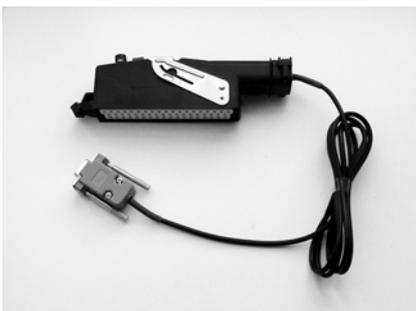
Программатор блоков ПБ-2М предназначен для модификации программного обеспечения электронных блоков управления (ЭБУ) Январь-5.х.х, VS-5.1 и Микас-7.х. Замена производится путем перепрограммирования встроенной Flash-памяти и EEPROM блока. Данная разработка предназначена для ремонтников, занимающихся тюнингом ЭБУ.
