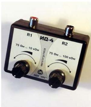
Имитатор датчиков ИД-4 предназначен для имитации выходного сопротивления резистивных датчиков электронной системы управления инжекторных двигателей.
