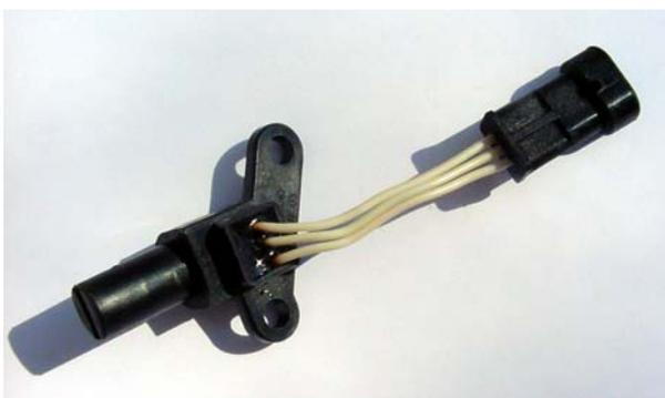
Датчик распределительного вала выдает один импульс на цикл работы двигателя – два оборота коленчатого вала (четыре такта), и позволяет блоку управления определить ВМТ такта сжатия первого цилиндра для синхронизации управления элементами системы с рабочим процессом двигателя.
