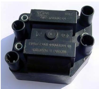
Модуль зажигания отвечает в системе за формирование высоковольтного напряжения на свечах зажигания. Модуль включает в себя высоковольтные ключи (коммутатор и 2 катушки зажигания). Блок управления формирует для модуля низковольтные управляющие сигналы, согласованные с положением коленчатого вала. Конец сигнала определяет начало искрового зажигания, длительность определяет степень заряда катушки и зависит от напряжения бортовой сети.
