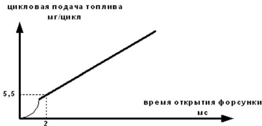
рис. 11. Типовая расходная характеристика форсунки
