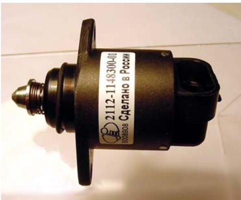
Шаговый мотор установлен в байпасном канале узла дроссельной заслонки. Положение вала шагового мотора определяет проходное сечение байпасного канала, необходимое для устойчивой работы двигателя при закрытой дроссельной заслонке.
