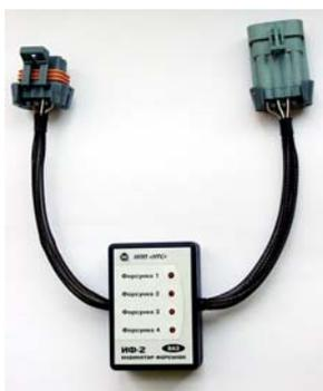
Индикатор форсунок ИФ-2 предназначен для индикации прохождения управляющих сигналов к топливным форсункам инжекторных двигателей ВАЗ. ИФ-2 подсоединяется в разрыв между форсуночным жгутом и жгутом ЭСУД.
