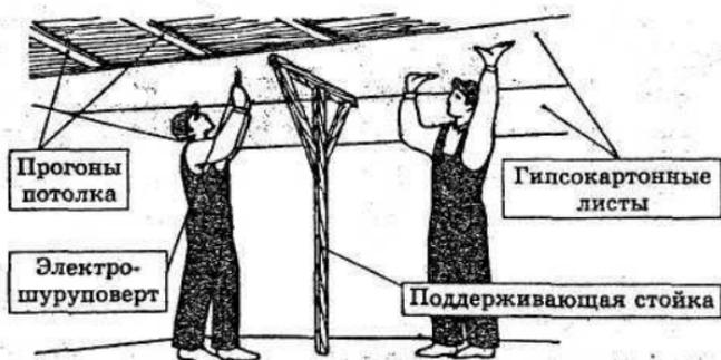
Рис. 9. Облицовка потолка ГКЛ
