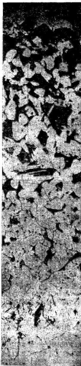
Фиг. 5. Микроструктура азотированного слоя, полученного при 800^\circ .
