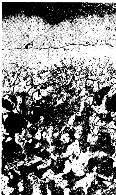
Фиг. 19. Микроструктура азотированного слоя на стали 45; азотирование при 650^\circ , закалка в масле.
