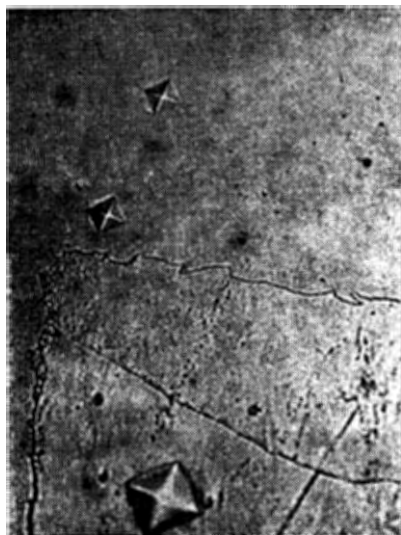
Фиг. 5. Образование однородного аустенита в пределах бывшего перлитного зерна стали 20 (исходное зерно № 2, температура нагрева 780^\circ ). \times 1500 .
