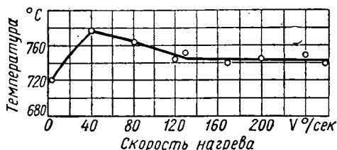
Фиг. 3. Сталь У10. Влияние скорости нагрева на положение критической точки. Электронагрев образцов со структурой пластинчатого перлита.
