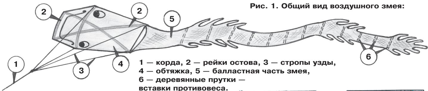
1 — корда, 2 — рейки остова, 3 — стропы узды, 4 — обтяжка, 5 — балластная часть змея, 6 — деревянные прутки — вставки противовеса.
