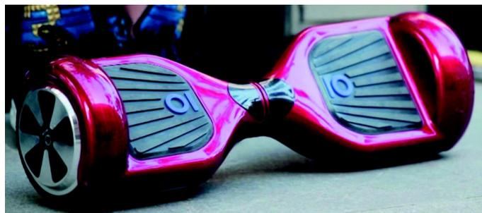
колесной доске, ни за что не держась. Но здесь вам поможет электроника доски. А дальше ее управление заключается в наклонах туловища ездока в ту сторону, в которую он желает ехать. Гироскопические датчики в корпусе доски улавливают сторону и угол наклона. Когда угол наклона доски достигает 15°, сигнал подается на управляющую электронику, та включает двигатели — и поехали.
