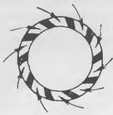
Фиг. 243. Образование кругового движения заряда в двухтактных двигателях.
