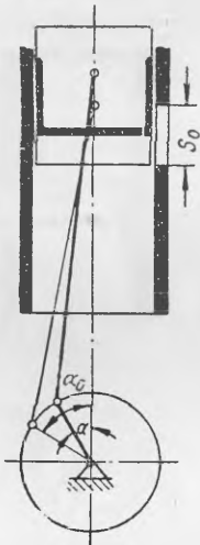
Фиг. 101. Схема кривошипно-шатунного механизма и расположения окон (для верхнего поршня двигателя с противоположно двигающимися поршнями)
