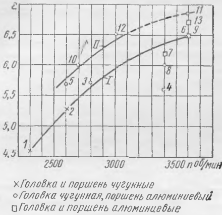
Фиг. 49. Влияние числа оборотов n коленчатого вала на допустимую степень сжатия в двигателях различных конструкций:
