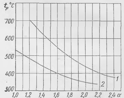
Фиг. 78. Зависимость температуры отработавших газов от коэффициента избытка воздуха \alpha для различных двигателей:
