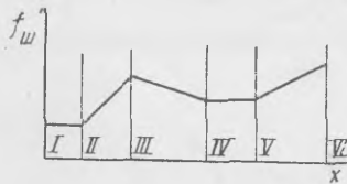
Фиг. 212. Зависимость эквивалентного сечения у штифта от подъема иглы.
