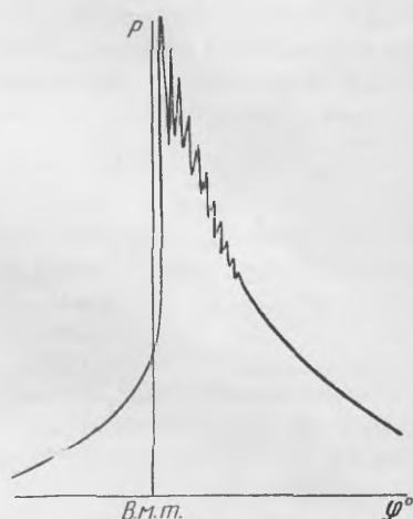
Фиг. 48. Вид индикаторной диаграммы при детонации.
