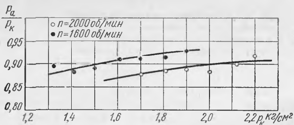
Фиг. 106. Изменение отношения p_a/p_k в зависимости от давления p_k для двухтактного двигателя с клапанно-щелевой продувкой
