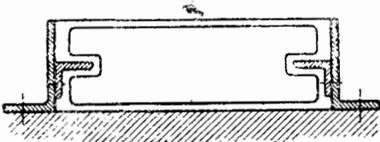
Фиг. 36. Профиль направляющей противовеса входит в выемку его.
