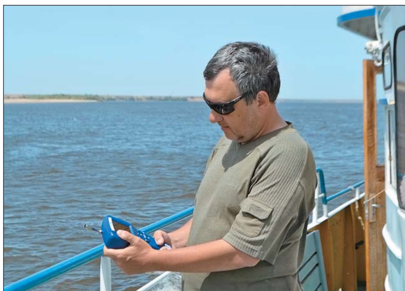
Рис.2. Сбор аэрозолей сетями (вверху) и измерение гранулометрического состава аэрозолей прибором AeroTrak на борту НИС «Академик Топчиев».
