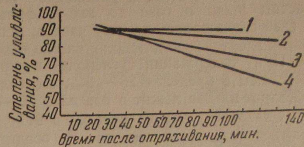
Рис. 86. Степень очистки в зависимости от длительности работы после встряхивания
