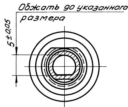
ШТУЦЕР ПРИВОДА КЛАПАНА ВОЗДУХА С ТРУБКОЙ В СБОРЕ
