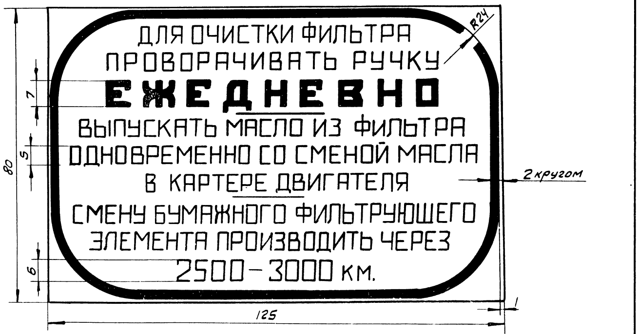
ИНСТРУКЦИОННАЯ ТАБЛИЧКА КОРПУСА МАСЛЯНЫХ ФИЛЬТРОВ
