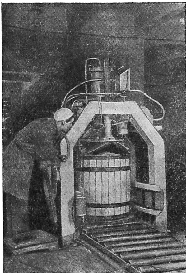
Рис. 151. Станок для укупорки бочек.
