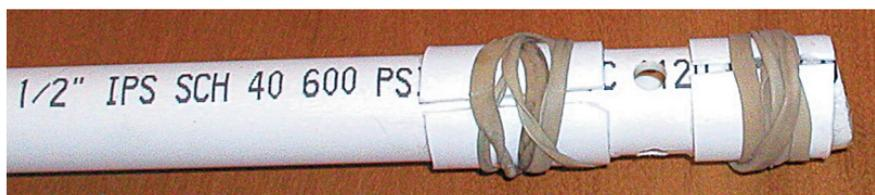
**Патрубки промазывают изнутри клеем, накладывают на трубку поршня в нужном положении, сверху обматывают резинкой и оставляют в таком положении до полного застывания клея.**
