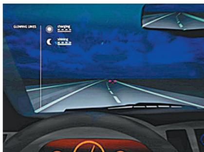
краска поглощает энергию света и таким образом «заряжается». А ночью — отдает свет в окружающую среду, не требуя дополнительного освещения шоссе, позволяет четко видеть дорожную разметку. Причем краска, химический состав которой держат в секрете, излучает интенсивное зеленое свечение — считается, что в темноте такой свет виден лучше всего.
