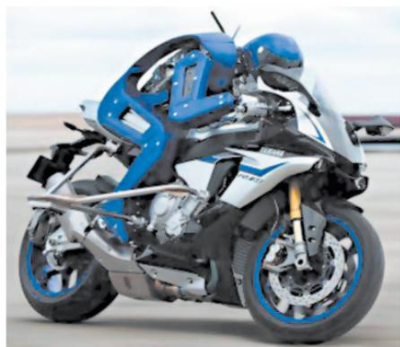
Одним из наиболее интересных экспонатов недавнего Токийского автосалона (Tokyo Motor Show) стал робот Motobot на мотоцикле Yamaha 1000cc R1M. А используют его для разработки полностью автоматической системы, которая сможет управлять «железным конем» на скоростях порядка 200 км/ч.
