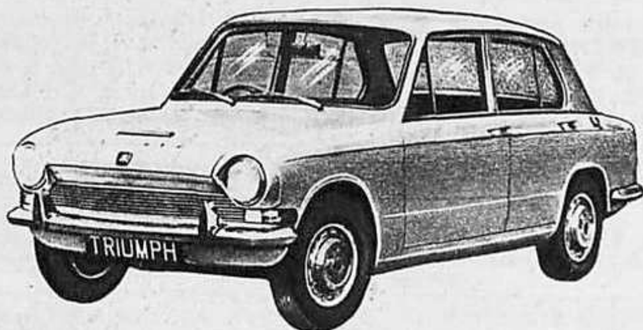
Автомобиль «Триумф-1300» (4 цилиндра, 1,3 л, 61 л. с., 914 кг, 135 км/час).
