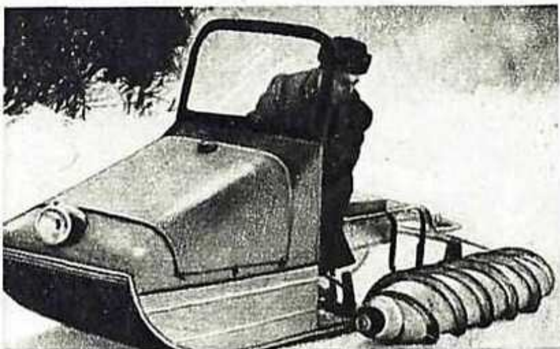
Снегоболотоход ГПИ-16Р с движителем-шнеком.
