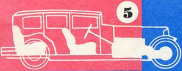
Рис. 4. Один из способов осуществить привод на передние колеса при зависимой подвеске [20-е годы].
