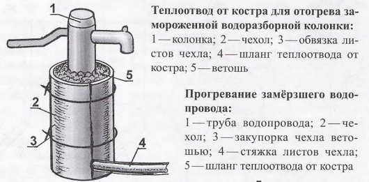
Тепловод от костра для отогрева замороженной водоразборной колонки:
