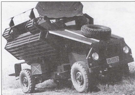
Патрульный автомобиль «Антилопа» с V-образным днищем и внешней противопульной облицовкой
