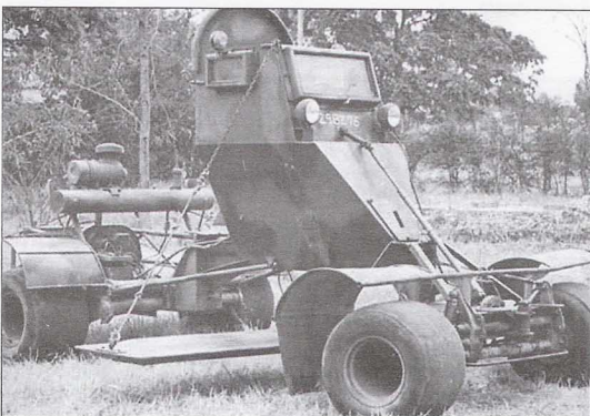
Миноскапель «Пукио» с бронированным корпусом-монококом на шасси автомобиля Lend Rover с колёсами от машин «Формула-1»
