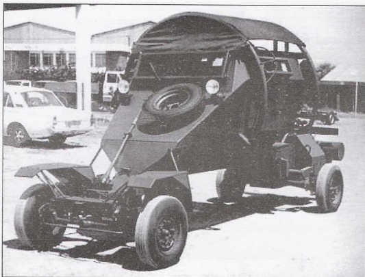
Взрывозащитный пассажирский 6-местный «Леопард» на шасси автомобиля Lend Rover. 1975 г.
