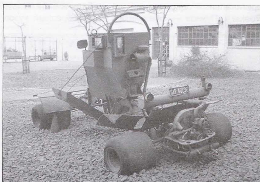
Миноскапель «Пукио» с бронированным корпусом-монококом на шасси автомобиля Lend Rover с колёсами от машин «Формула-1»
