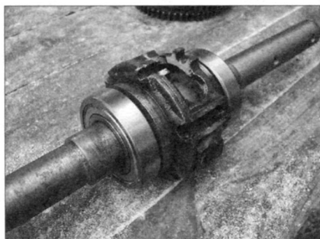
Вторичный вал редуктора (приводной вал колёс и фрез)
