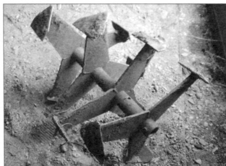
Фреза-культиватор промышленного производства для самодельного мотоблока
