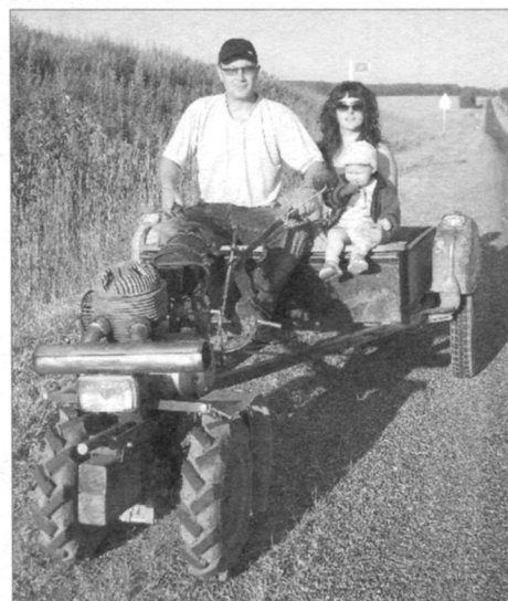
Мотоблок в транспортном варианте с грузовой прицепной одноосной тележкой, изготовленной на шасси двух боковых прицепов мотоцикла «ИЖ-56»
