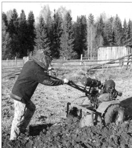
Мотоблок с окучником из дисковых культиваторных фрез
