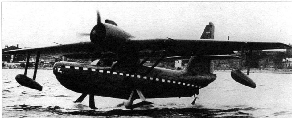
Летающая лаборатория для исследования возможности использования подводных крыльев в качестве взлётно-посадочных устройств гидросамолётов
