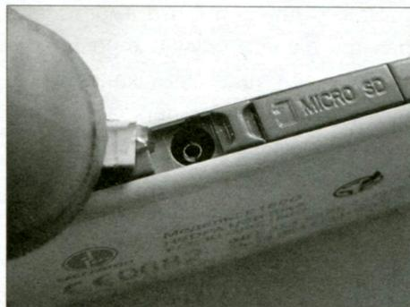
Фото 2. Вид на гнездо разъёма интернет-модема E160G
