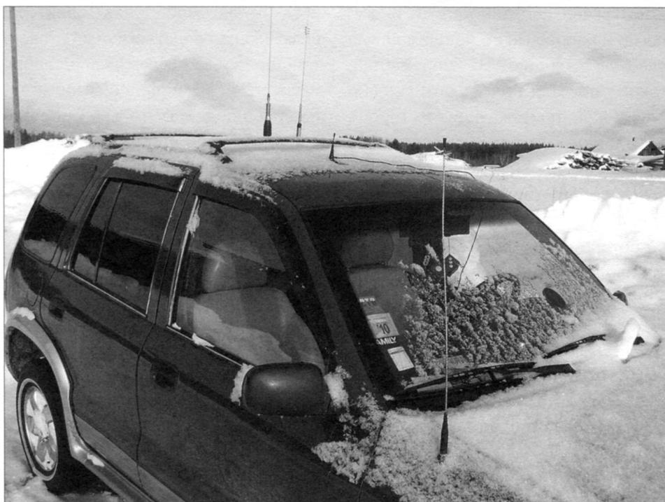
Фото 6. GSM-антенна (самая короткая) на крыше автомобиля
