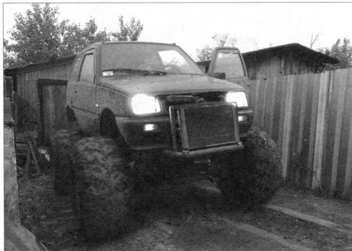
Кузов и двигатель вездехода — от «Оки», хотя поначалу поставил силовой агрегат от ВАЗ-2109, но он оказался тяжеловат. Колёса (диски и ободья) — самодельные, а шины — фирмы ШАИНА. Ходовая часть — от внедорожника «Нива-2121».
