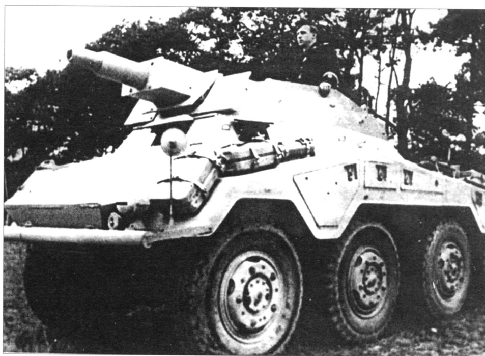
Броневедомка Sd.Kfz.234/3 с короткоствольной 75-мм пушкой
