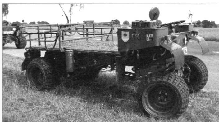
Крака (от немецкого Kraftkarren – рабочая тележка) – многоцелевой складной автомобиль-транспортёр воздушно-десантных войск бундесвера, разработанный немецкой фирмой Zweirad Union
