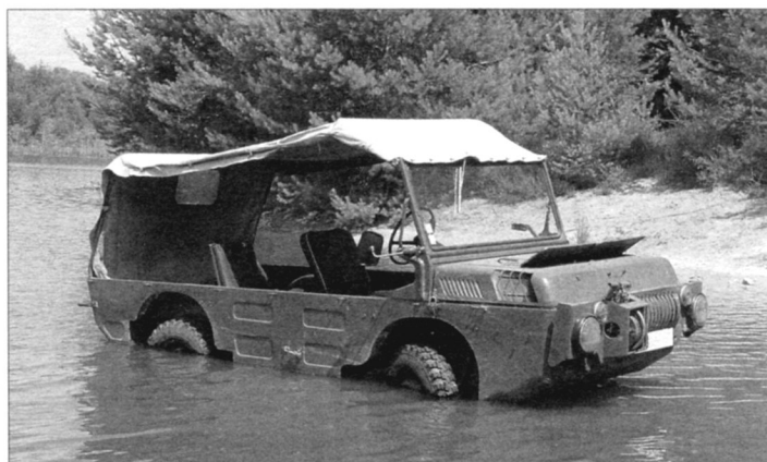
Транспортёр ЛуАЗ-967 неплохо плавал – в движение его приводили собственные колёса
