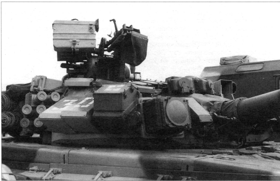
Башня Т-90 крупным планом. Над стволом пушки установлены приёмные головки обнаружения лазерного излучения, а справа от пушки – правый осветитель системы оптико-электронного подавления «Штора-1»
