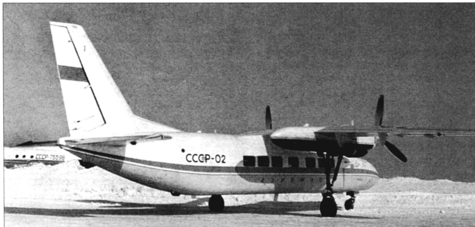
Второй экземпляр Бе-30 с двигателями ТВД-10 опытной серии после доработки получил регистрационный номер СССР – 67206
