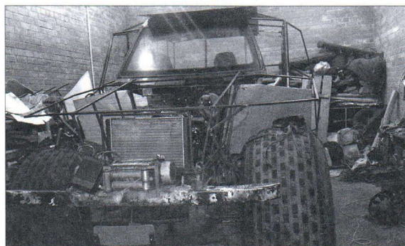
Каркас кузова в процессе изготовления
