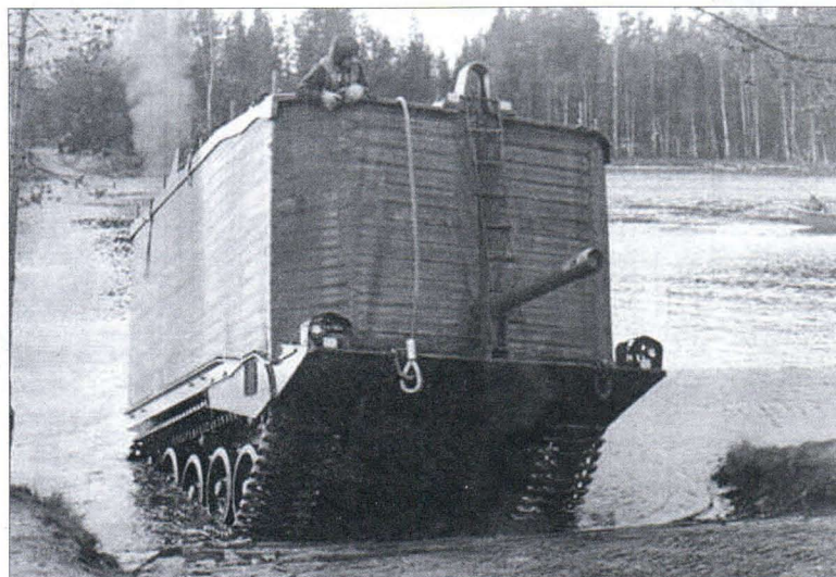
Выход танка Strv-103A на берег после преодоления водной преграды
