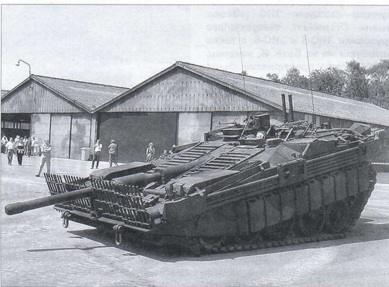
Гидропневматическая регулируемая подвеска Strv-103A позволяет наводить пушку на цель наклоном корпуса
