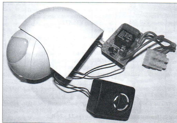
Датчик движения ДД-010 в разобранном виде с вынутой платой исполнительного устройства и дополнительно подключённой сиреной (сила звука 100 дБ) типа KPS-4510
