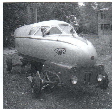
Колёсный вариант (снегоход, переоборудованный в вездеход)
