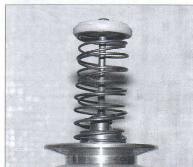
Ведомый шив и возвратная пружина, внутри пружины видна концевая втулка и верхний конец шпинделя в крайнем верхнем положении
