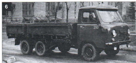
Экспериментальные автомобили Ульяновского автозавода: 1 – плавающий четырёхгусеничный снегоболотоход УАЗ-492; 2 – гусеничный вездеход с активным гусеничным прицепом; 3 – лыжно-гусеничный автомобиль на базе УАЗ-450; 4 – железнодорожная автомотрисса на базе микроавтобуса УАЗ-450В; 5 – седельный тягач с прицепом-рефрижератором; 6 – трёхосный грузовой автомобиль с деревянной бортовой грузовой платформой
