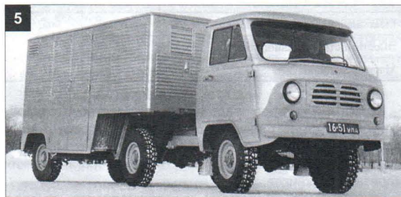
Экспериментальные автомобили Ульяновского автозавода: 1 – плавающий четырёхгусеничный снегоболотоход УАЗ-492; 2 – гусеничный вездеход с активным гусеничным прицепом; 3 – лыжно-гусеничный автомобиль на базе УАЗ-450; 4 – железнодорожная автомотрисса на базе микроавтобуса УАЗ-450В; 5 – седельный тягач с прицепом-рефрижератором; 6 – трёхосный грузовой автомобиль с деревянной бортовой грузовой платформой
