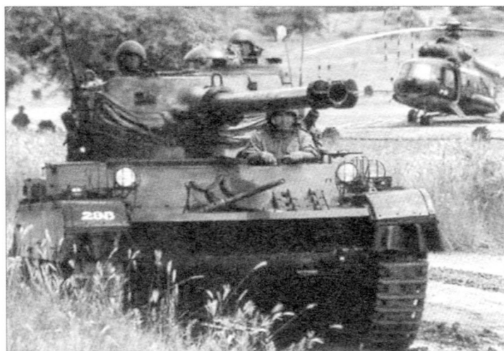
Экипаж танка состоит из трёх человек. В левой части башни – командир, справа от пушки – наводчик, механик-водитель – слева в отделении управления
