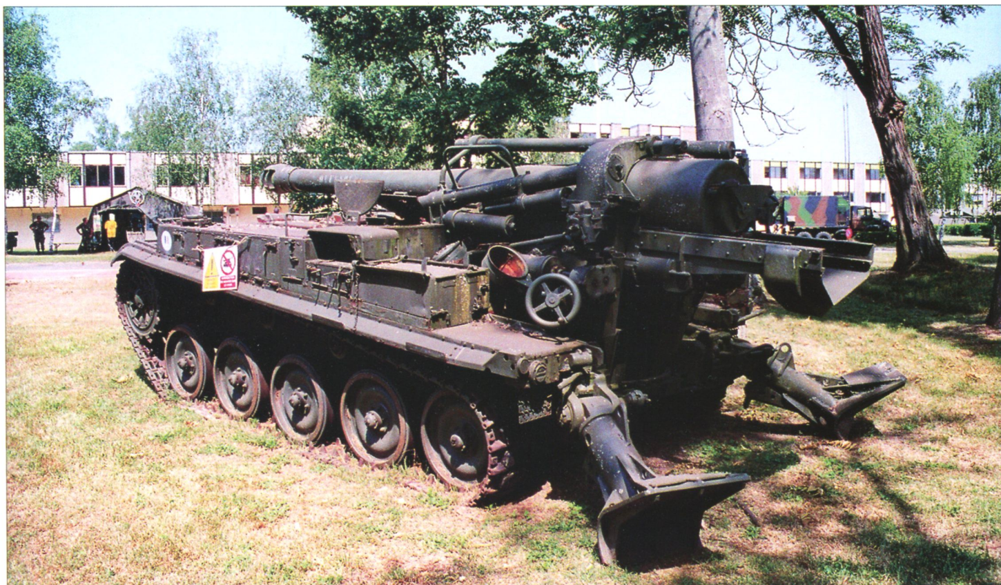
155-мм французская самоходная установка АМХ-13 F3 АМ на базе танка АМХ-13. Дальность стрельбы – 20 км, расчёт – 8 человек
