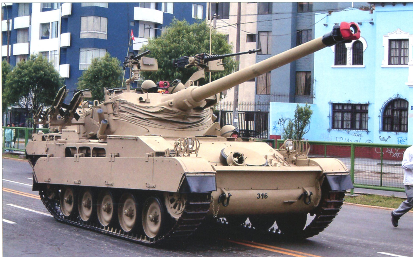
Лёгкий танк АМХ-13, вооружённый четырьмя ракетными пусковыми установками и двумя башенными пулемётами
