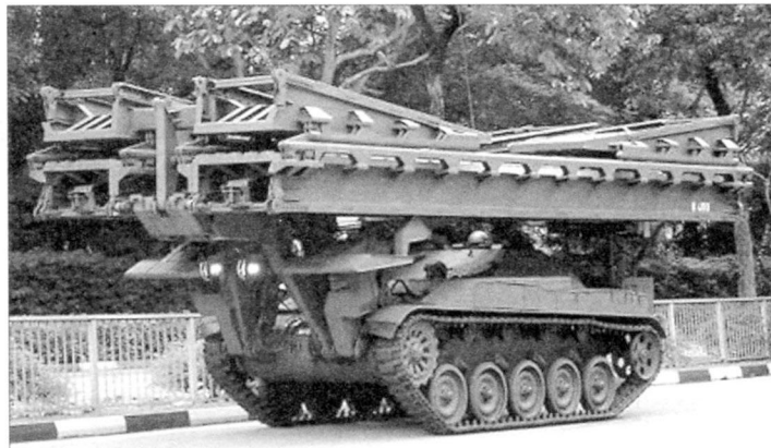
Мостовкладчик на шасси АМХ-13
