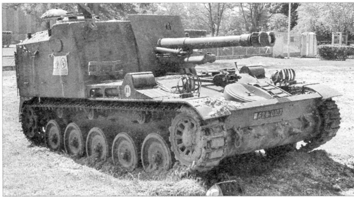
Самоходная установка АМХ 105 АМ с 105-мм гаубицей Мк61 с открытой сверху рубкой на базе АМХ-13
