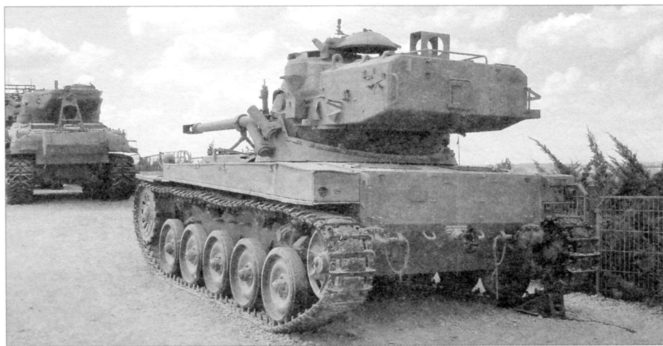
AMX-13 снабжён длинной кормовой нишей, в которой находятся автомат заряжания и часть боекомплекта снарядов
