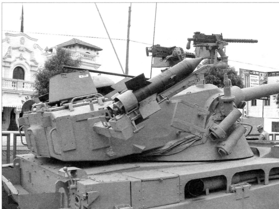
Качающаяся башня танка. На ней размещены пусковые ракетные установки, пулемёты и блоки дымовых гранат
