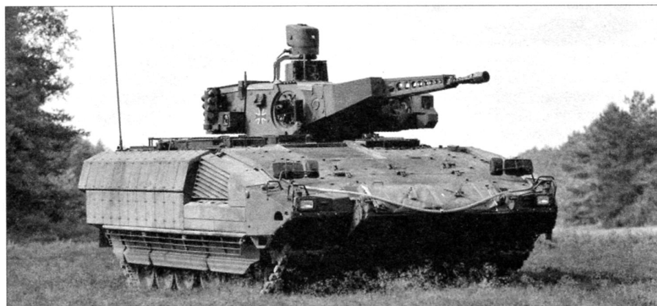
БМП «Пума» уровня «С» с модульной защитой. Масса машины около 43 т
