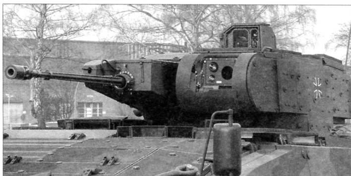
Башня БМП. Справа в башне – 30-мм автоматическая пушка МК 30, за ней – 5,56-мм пулемёт
