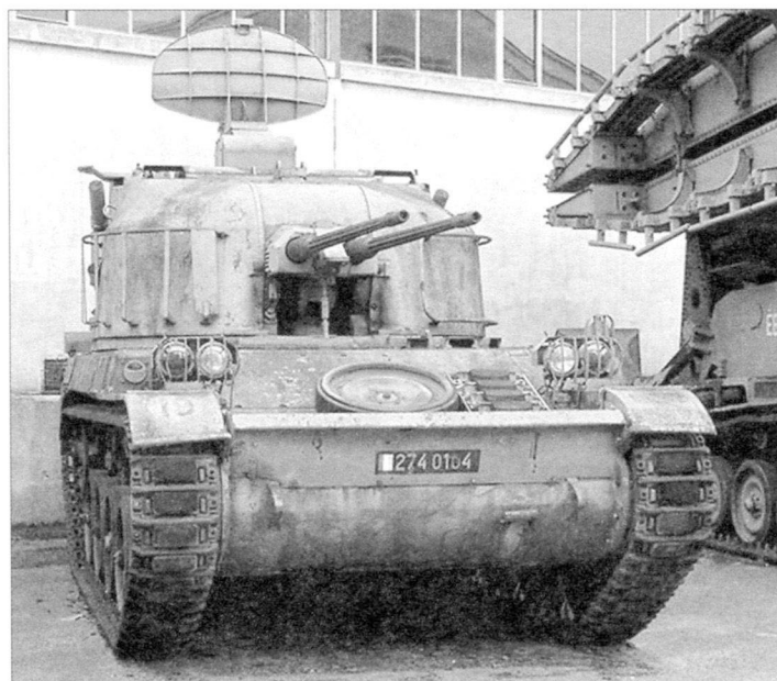
Зенитная самоходная установка AMX-13DCA с двумя 30-мм орудиями. Создана на базе танка AMX-13, на вооружении французской армии с 1969 г.
