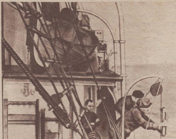
Научные сотрудники ледокола опускают в море батометр — прибор для получения проб воды с различных глубин.
