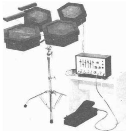
**Описанное устройство служит для имитации ударных инструментов и способно генерировать нетрадиционные звуки. Оно может быть укомплектовано "тарелками" и "хетом" и используется как самостоятельный инструмент либо как электронное дополнение к традиционной ударной установке.**
