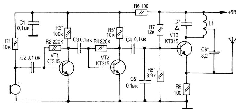
усилителя низкой частоты (УНЧ), собранного на транзисторах VT1, VT2, и задающего генератора ВЧ на транзисторе VT3. УНЧ обладает достаточно большой чувствительностью.
