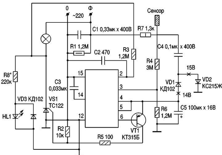
Подбирая R8 при выключенной лампе, добиваются желаемой яркости свечения HL1. Мощность лампы ограничивается параметрами применяемого VS1.
