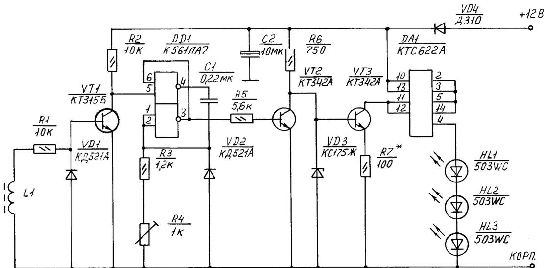
Вывод 16 микросхемы DD1 соединить с выводом 10 транзисторной сборки DA1, а вывод 8 – с корпусным проводом
