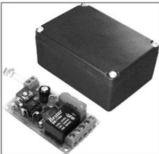
**New!** С помощью этого устройства можно автоматизировать включение-выключение ночного освещения в прихожей многоквартирной квартиры, в подъезде жилого дома или уличного освещения на дачном участке. Прибор позволяет регулировать порог включения-выключения, имеет небольшие размеры, обладает высокой надежностью, не дает помех по электросети.
