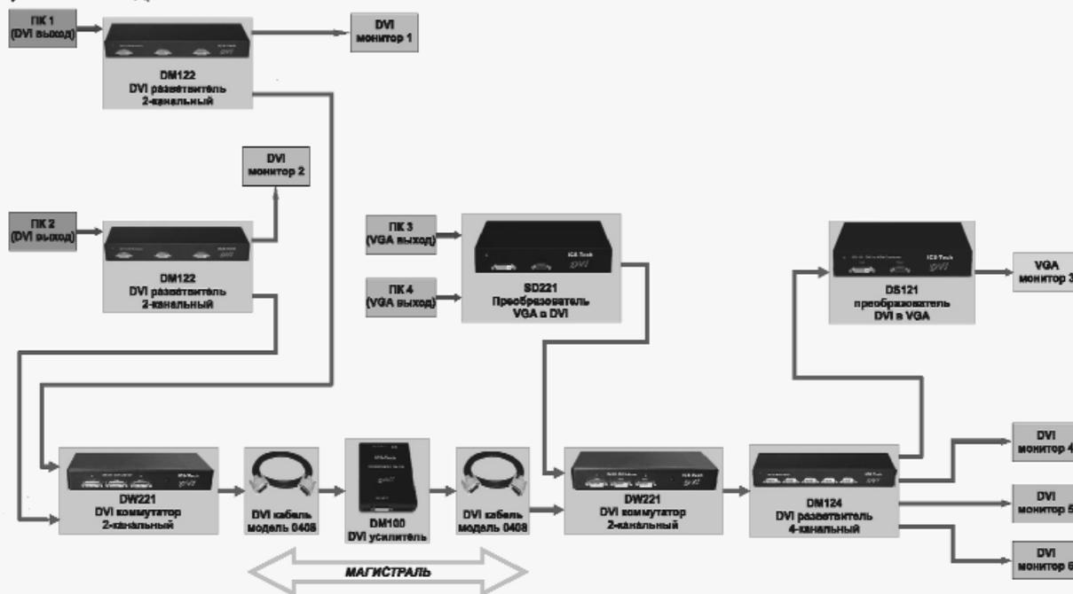
Рисунок 1. Пример построения видео системы с использованием DVI оборудования компании "ИКС-Техно".
