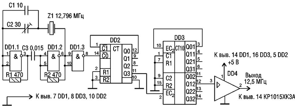
DD1 K155ЛА3, DD2 K155ИЕ5, DD3 K561ИЕ10, DD4 K561ПУ4
