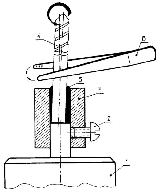
та вся операция занимает не более 3...10 мин. Необходимо отметить, в стандартные цанговые патроны дрелей не удается надежно зажать сверла малого диаметра – они проворачиваются. Автор наматывает на хвостовую часть сверла виток к витку провод диаметром 0,41...0,62 мм. Сверло зажимается в патроне довольно надежно. Опасность поломки сверл при работе с тяжелыми электродрелями все же существует.
