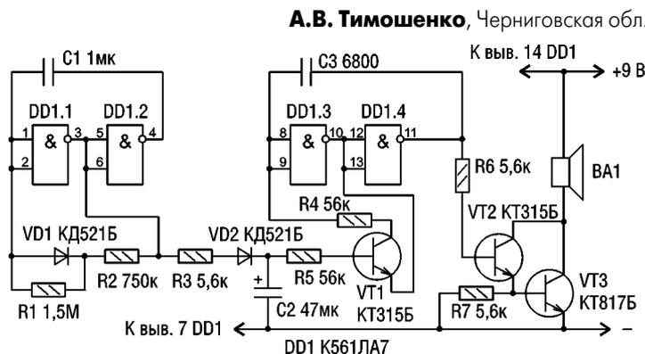
Для устройства пригодны транзисторы VT1, VT2 серий KT312, KT315, KT3102; VT3 — серии KT815, KT817, KT805. Микросхему можно применить типа K176ЛА7, K561ЛА7, K564ЛА7, K176ЛЕ5, K561ЛЕ5. Микросхему желательно установить на панельку. Громкоговоритель BA1 любого типа мощностью 3...10 Вт.
