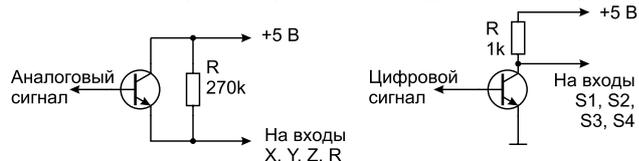
Рис.2. Схема сопряжения для аналоговых (слева) и цифровых (справа) сигналов
