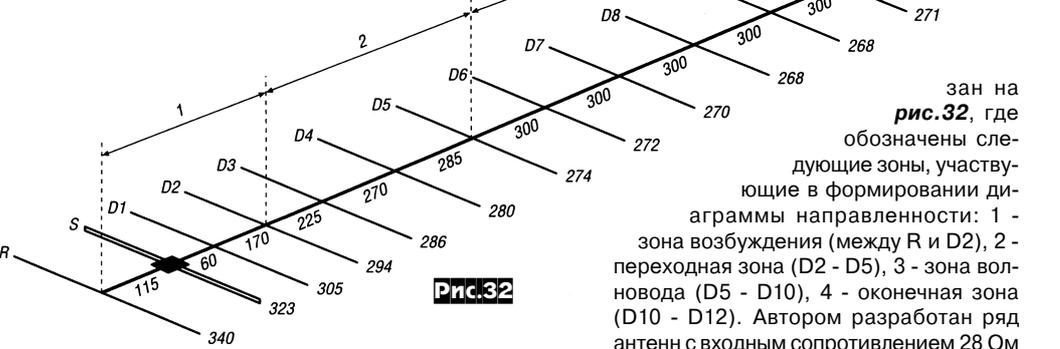
зан на **рис. 32**, где обозначены следующие зоны, участвующие в формировании диаграммы направленности: 1 - зона возбуждения (между R и D2), 2 - переходная зона (D2 - D5), 3 - зона волновода (D5 - D10), 4 - оконечная зона (D10 - D12). Автором разработан ряд антенн с входным сопротивлением 28 Ом
