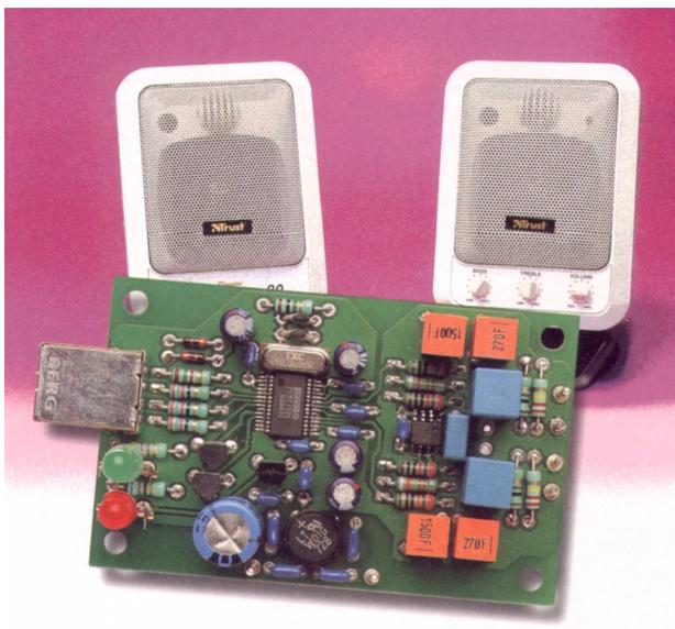
ройство потребляет ток 60 мА и может питаться от USB-шины. Но поскольку возможности последней ограничены током 100 мА, рекомендуется применять для питания блок (рис. 14) на мостике и интегральном стабилизаторе IC3, подключаемый к любому источнику постоянного напряжения не менее 9 В или переменного не менее 8 В («Elektor Electronics» №12/00, с.44-48 \*).
