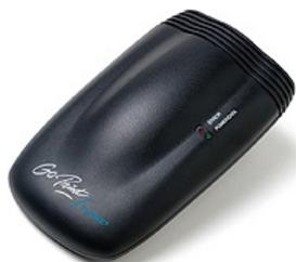
и перегородки) и на 300 м при прямой видимости. То есть если Power Rover является радиоэквивалентом RS-232-кабеля, то **GoPrint является радиоэквивалентом LPT**. ПО под Windows и DOS позволяет объединить в одну радиосеть до 128 ПК и до 8 принтеров.
