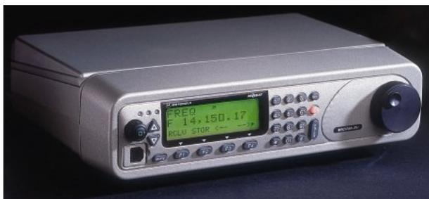
выходной мощности, перестраиваемый режекторный фильтр, субоктавный преселектор. Частотный диапазон: прием 100 кГц - 30 МГц; передача - все радилюбительские КВ диапазоны. Количество каналов памяти 200, нестабильность частоты 0,00006%. Разрешающая способность по частоте 10 Гц. Полоса НЧ по уровню -6 дБ: 350-2700 Гц (голос), 650-1150 Гц (CW), 1450-1950 Гц (низкоскоростной цифровой поток), 350-3300 Гц (высокоскоростной цифровой поток).
