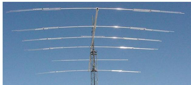
лучения вперед/назад (F/B, dB) - от 25 до 29 (28,0-28,8 МГц), 19-24 (21,0-21,4 МГц), 17-26 (14,0-14,3 МГц). Входное сопротивление 50 Ом, коннектор SO-239. Подводимая мощность 3 кВт. Длина траверсы 9,76 м, диаметр 76,2 мм. Длина наибольшего элемента 7,62 м. Радиус вращения антенны 6,56 м. Площадь сопротивления ветру около 3 м<sup>2</sup>, а расчетная ветровая нагрузка - до 160 км/час.
