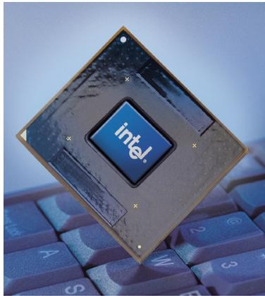
SpeedStep™ процессор умеет определять, когда ПК «саб-ноутбук» подключен к сети, а когда питается от аккумуляторов, и в первом случае выдает максимальную производительность (тактовая частота 500 МГц, системная шина 100 МГц), а во втором - переходит на экономичный режим (300 МГц) с **потреблением всего 0,5 Вт**. Система QuickStart уменьшает потребление еще ниже, затормаживая процессор на время даже коротких пауз, например, между нажатием клавиш при наборе текста (это только ка-
