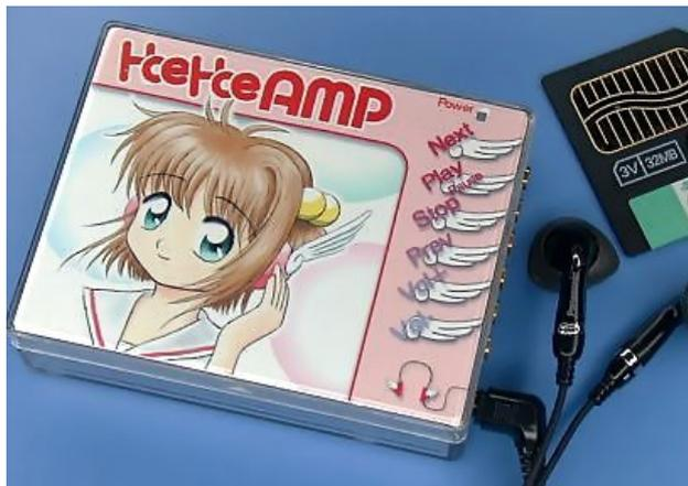
MAS3507D (рис. 3, см. с.42) преобразователь напряжения. Привычный «выключатель» отсутствует - его функции выполняют кнопки «PLAY/PAUSE» SW3 и «STOP» SW4, соответственно включающие/выключающие питание через ключи Q1-Q4 с электронной «защелкой» на микроконтроллере U1. Кнопки «NEXT», «PREV», «VOL+», «VOL-» обеспечивают переход к следующей/предыдущей музыкальной композиции и увеличивают/уменьшают громкость.
