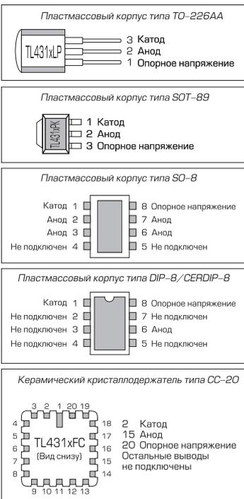
Рис. 2 Назначение выводов для разных типов корпусов
