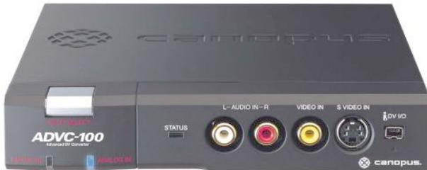
фон DV-формата через IEEE 1394 (i.Link, FireWire) интерфейс. Звук можно преобразовать в форматы 48 кГц/16 бит/2 канала или 32 кГц/12 бит/4 канала, причем в устройстве применены специальные меры по предотвращению рассинхронизации звука и видео. Конвертер питается от сети через адаптер 5 В / 5,5 Вт, имеет габариты 146x120x17 мм и цену \$299.
