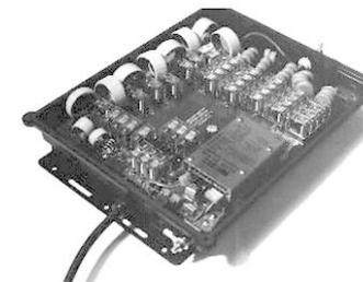
Автоматический антенный тюнер SG-235 фирмы SGC@World (http://www.sgcworld.com) с микропроцессорным управлением работает в диапазоне 1,8...30 МГц при подводимой мощности не более 500 Вт со многими типами антенн, в т.ч. и проволочными, длиной более 35 футов.
