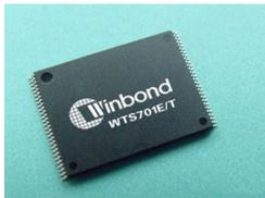
росхема **WTS701** стоит меньше \$10, но позволяет преобразовывать в реальное время текстовый файл в формате ASCII или Unicode, поступающий через последовательный SPI-порт, в произносимый электронным «диктором» аналоговый звук без дополнительных сигнальных процессоров, памяти, кодеков
