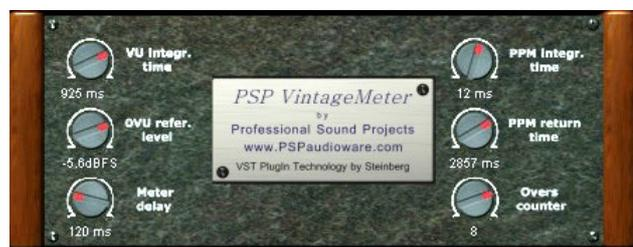
стереофонический стрелочный VU-метр или пиковый измеритель уровня с регулируемым временем интегрирования, возврата, уровнями и проч.
