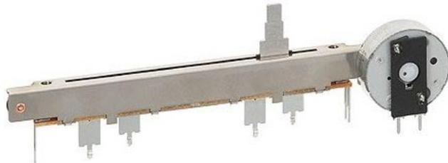
млн. циклов (обычные потенциометры, как правило, 50 тысяч). **Ползунковые (ход 60 мм) переменные резисторы серии EVANS** (<http://www.maco.panasonic.co.jp/htm-bin/maco/topics/02097e.html>) снабжены электроприводом и предназначены для автоматических эквалайзеров, микшеров и т.п. аудиоустройств.
