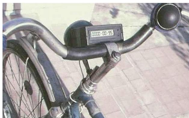
зом, чтобы каждую миллисекунду происходило прерывание. Обработчик прерываний от таймер-счетчика RTCC подсчитывает количество миллисекунд, прошедших с момента начала оборота колеса, т.е. с момента срабатывания геркона.
