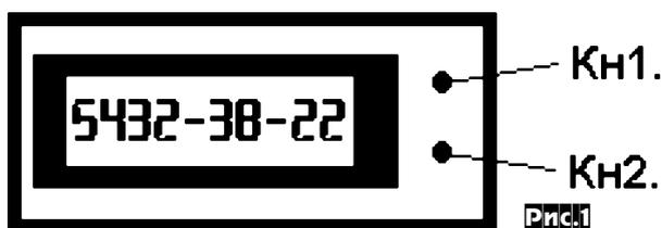
на **рис. 1**, а на **фото** справа показан внешний вид спидометра, установленного на руле велосипеда. Четыре цифры слева показывают общий путь (в диапазоне от 0000 до 9999 км), две средние цифры - текущий путь (в диапазоне от 00 до 99 км), две цифры справа - скорость от 0 до 99 км/ч.
