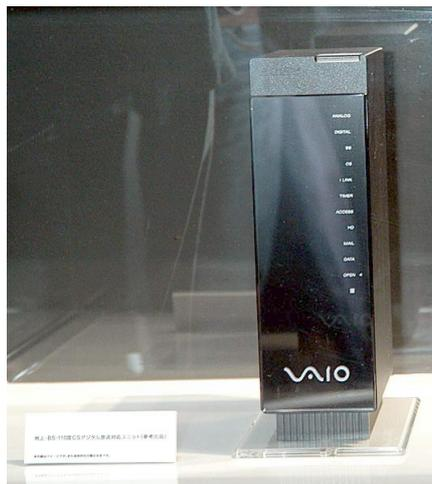
имеет архитектуру, близкую к персональному компьютеру (предусмотрена возможность работы как ПК, для чего имеются беспроводные мышь и клавиатура) и оснащен несколькими жесткими дисками общей емкостью более 1 терабайта. Этого достаточно для записи 1272 часов видео высокого качества (DVD) или 212 часов ТВ высокой четкости
