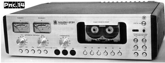
ный стационарный магнитофон нового поколения на интегральных схемах «Маяк-231» (рис. 14). Сам ЛПМ был значительно доработан и усовершенствован.
